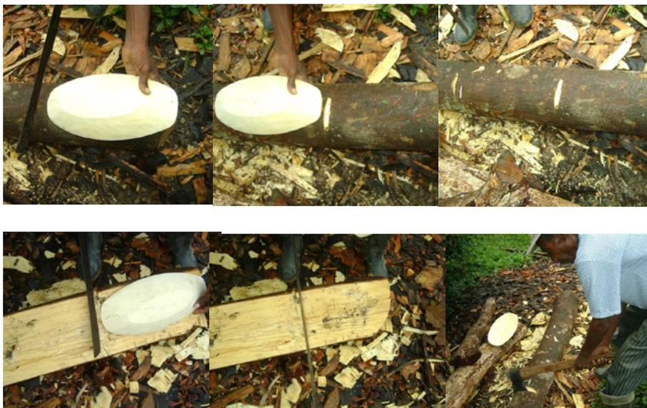
**Figura 34.** Cortes del tronco para obtener moldes de bateítas. Marcación adversa tomando como referencia la longitud esencial de la forma
